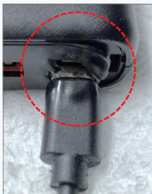
充電端子が溶けている接続部
