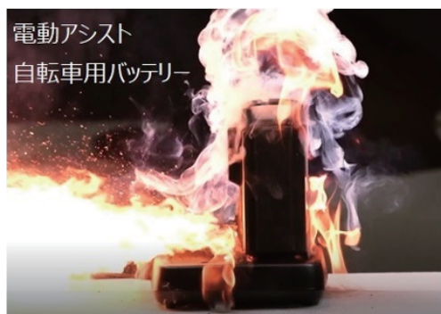
写真1 電動アシスト自転車用バッテリーが発火したようす(NITE再現実験)
