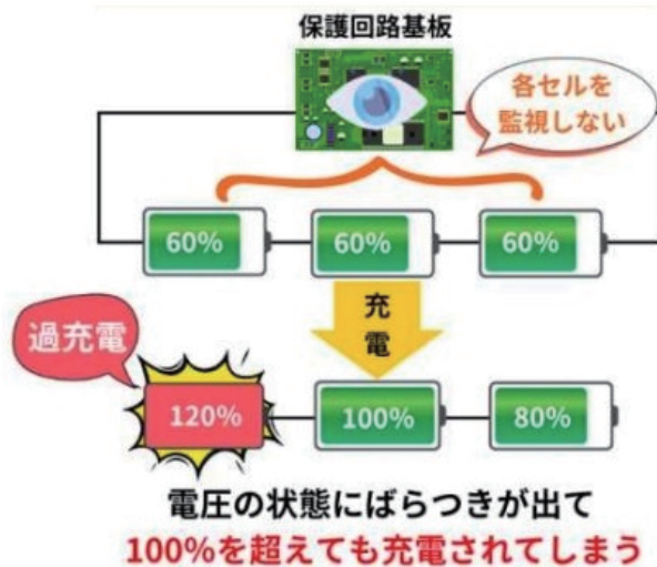
図7 アンバランスを検知する回路がない場合
