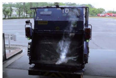
写真2 ごみ収集車にモバイルバッテリーが挟まれて発火しているようす (NITE再現実験)
