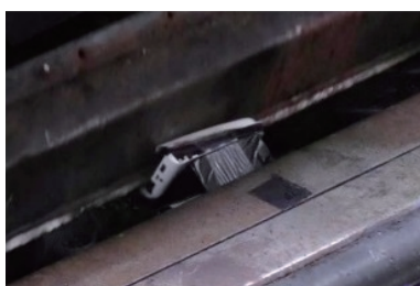
写真2 ごみ収集車にモバイルバッテリーが挟まれて発火しているようす (NITE再現実験)
