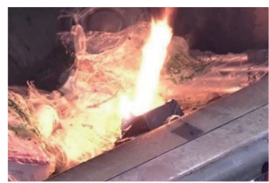
写真2 ごみ収集車にモバイルバッテリーが挟まれて発火しているようす (NITE再現実験)
