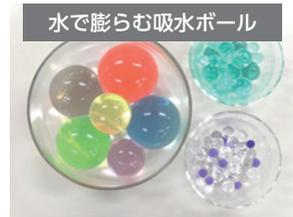
テストでは、体内に入ったことを想定して腸液を模した試験液に浸せきしたところ、胃液を模した試験液に浸せきしたときよりも大きく膨らみ、最も大きくなったもので24時間後に直径15mm程度のものが40mm近くになりました。
