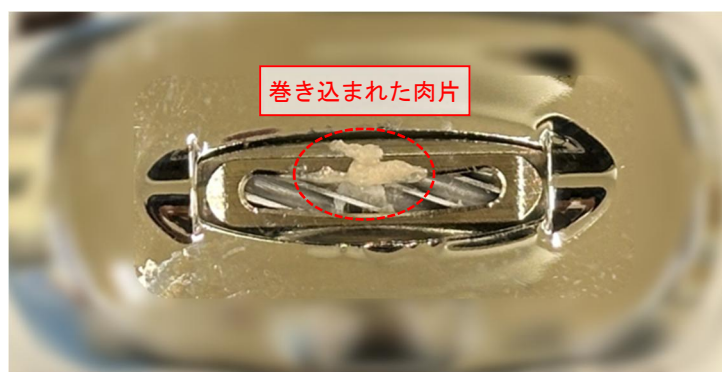
図 15 テスト後、回転刃に巻き込まれた肉片
