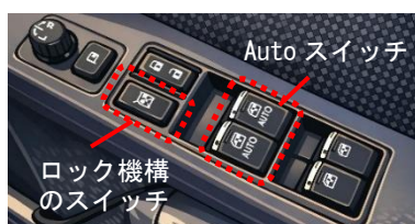
図2. 運転席のパワーウインドスイッチの一例
