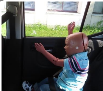
チャイルドシート有 ＝ベルトが外れた状態＝
