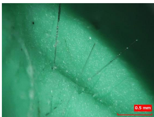
写真4. 新品の傘の骨を粘土で擦ったところ付着したガラス繊維
