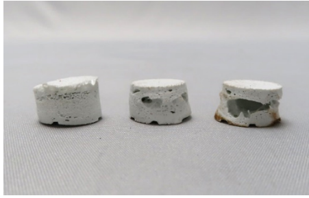
写真. 耐摩耗性試験の試験片の断面
