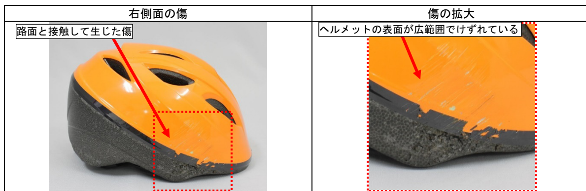
写真6. 転倒した際に路面と衝突し損傷したヘルメットの例
