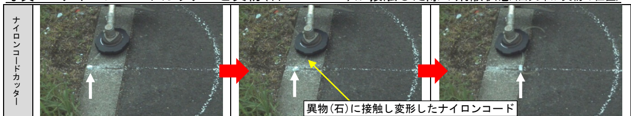
写真8. ナイロンコードカッターと異物(石 20~30 mm)が接触した際の飛散状態(白矢印が異物の位置)
