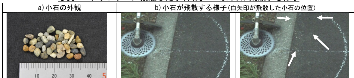
写真6. チップソーに接触した小石(約5mm以下)が飛散する様子
