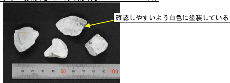
写真1. 刈刃に接触させた異物(約20～30mmの石)
