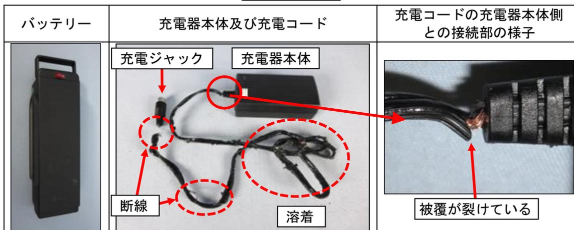
当該品 2 のバッテリーを分解したところ、充電コードが接続される充電コネクタは、内部のバッテリーの端子とコードで直結されており、バッテリーからの電圧が常にかかっている状態でした。このため、充電コードを被覆が裂けるなど損傷した状態で充電コネクタに接続すると、芯線が短絡し、バッテリー側から充電コードに電流が流れてコードが発煙・発火する可能性が考えられました(図)。
