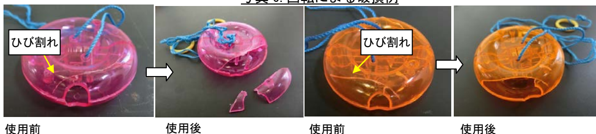
写真 6. 回転による破損例
