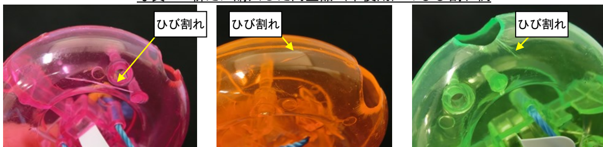
写真 4. 新たに購入した同型品（未使用）のひび割れ例
