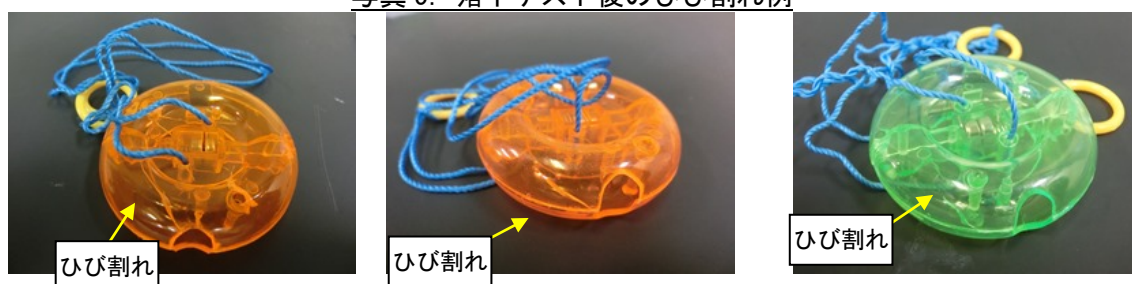
写真 5. 落下テスト後のひび割れ例
