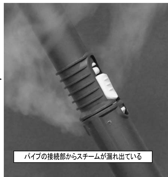
写真2. スチームが漏れ出ている様子
