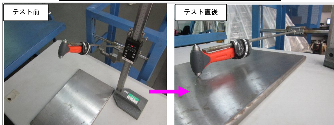
写真5. 特定温度でのハンマー強度、機能、耐久性テスト風景
