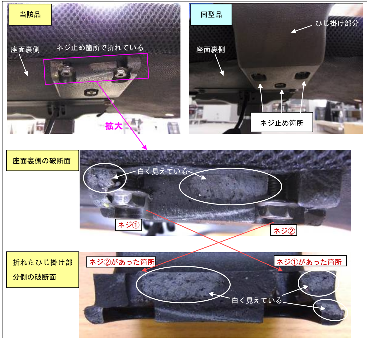
写真 2. 破断面（例：右側ひじ掛け部分）
