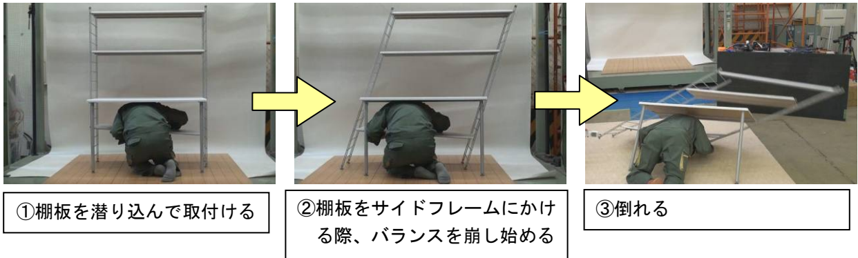
写真2. 再現テストでバランスを崩す様子
