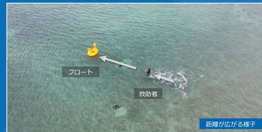
風速2~4m/sの風が断続的に吹く中、フロートは約0.6m/sの速さで漂流し、110秒後には海岸から約50mの位置まで流されました。水深が深くなると、救助者の動きが遅くなり、フロートとの距離が広がりました。
