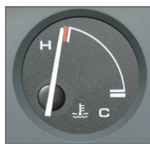
写真4 水温計 (オーバーヒート状態) 赤い線は危険なオーバーヒート状態であることを示す。
