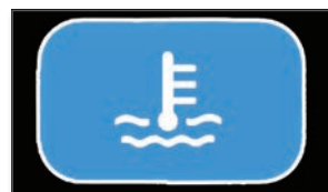
写真6 ランプ式(適温以下) 適温以下の状態では青ランプが点灯している。
