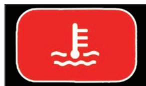
写真5 ランプ式 (オーバーヒート状態) オーバーヒート状態になると赤ランプが点灯する。
