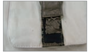
写真6 合成皮革部の剥離事例
