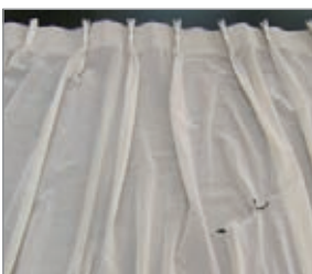
写真1 カーテンの破損事例
