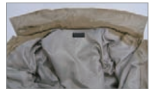
写真12 裏面樹脂のにじみ出 しによるしみ
