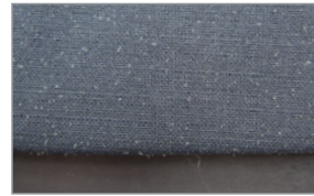
写真3 ポリウレタンの飛び出し事例（背広/ループ状）
