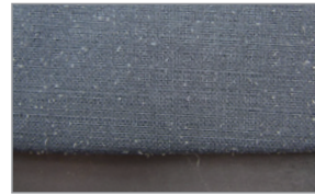
写真3 ポリウレタンの飛び出し事例（背広/ループ状）
