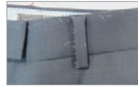
写真5 ポリウレタンの飛び出し事例（スラックス/ヒゲ状）
