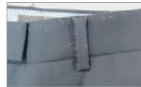
写真5 ポリウレタンの飛び出し事例（スラックス/ヒゲ状）
