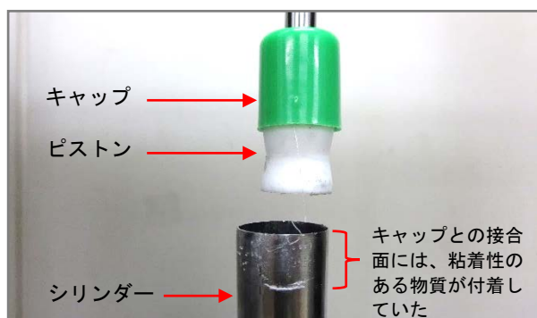
写真 2. シリンダーからキャップが外れた様子
