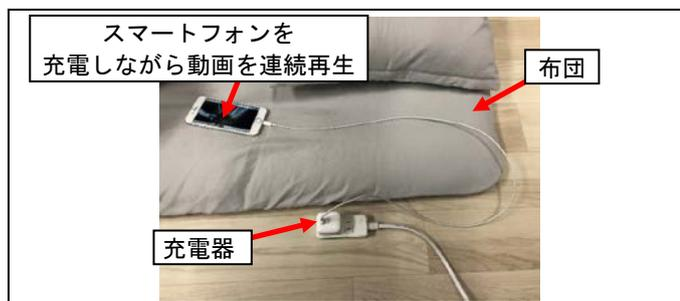
写真8. スマートフォンの発熱テスト (iOS 端末の例)
