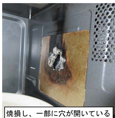
写真2. 損傷したマイクロ波の出口カバー
