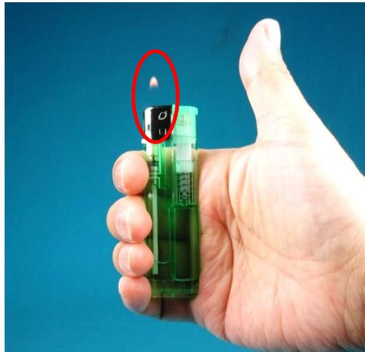
※ 使い捨てライターに異物（厚さ約 2.3mm の砂利）が混入したと想定して、残り火を発生させた再現写真です。実際の事件事例とは異なります。
