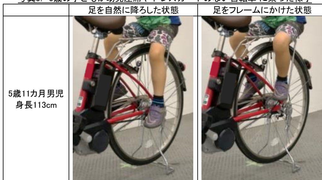
写真3. 5歳の子どもが幼児座席やドレスガードのない自転車*に乗った様子
