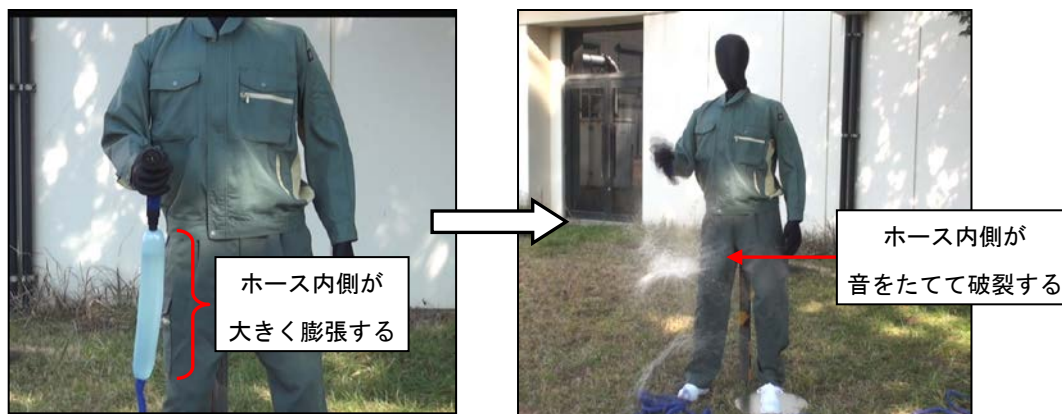
写真10. ホース内側破裂の様子(写真は一例)
