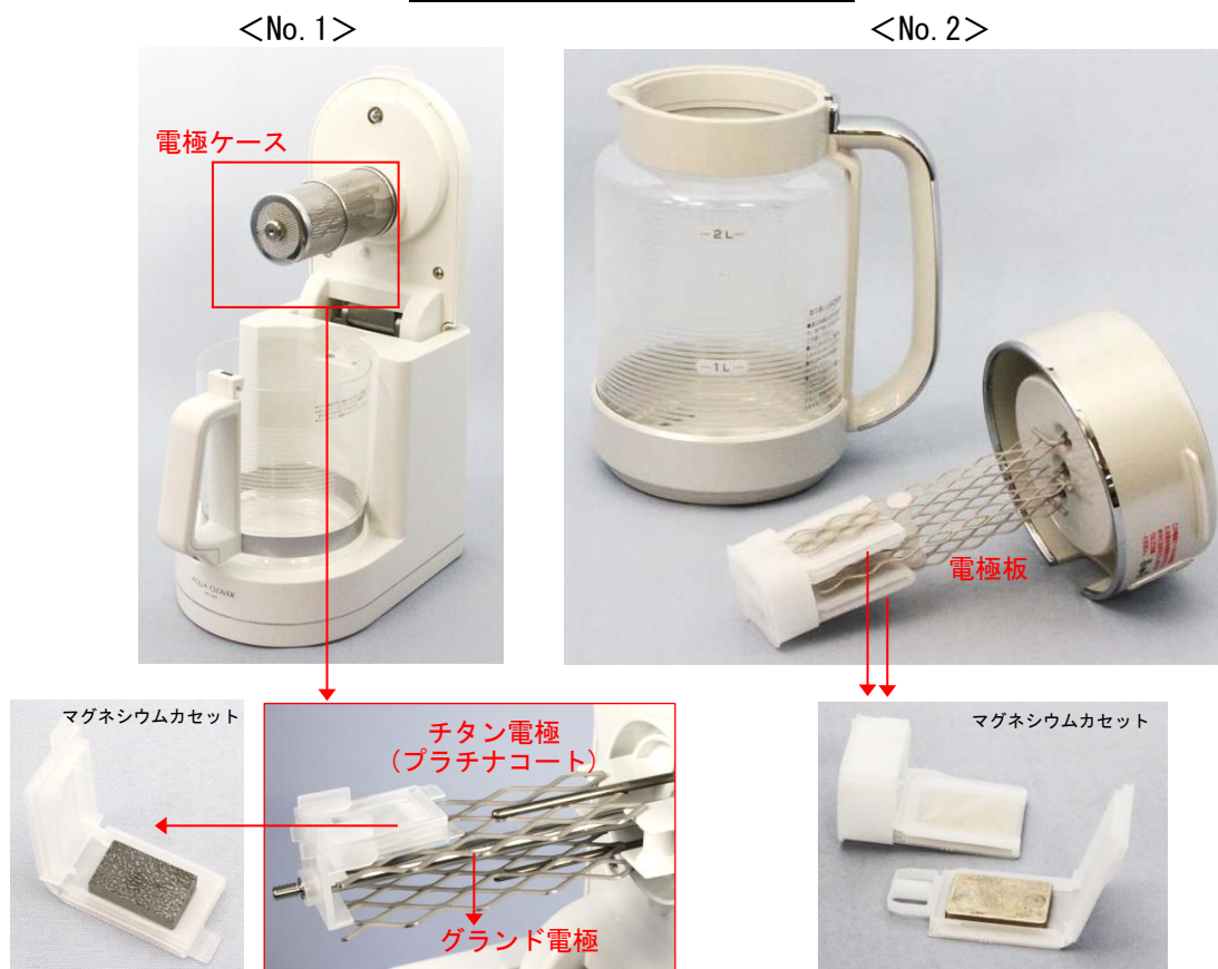
写真 2. テスト検体 電極の外観
