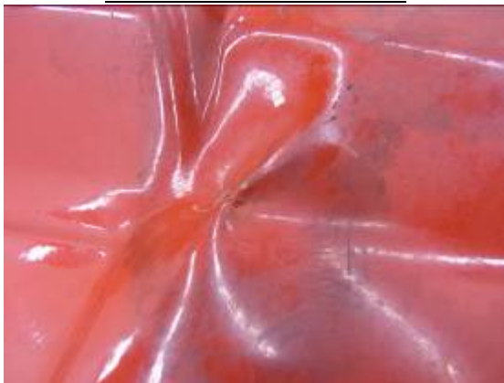
写真1. 下面の変形と染み
