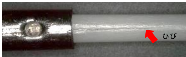
露先のかしめ部のひび割れ
