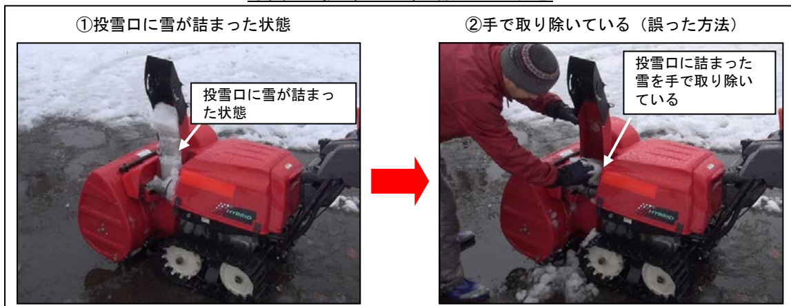
写真7. 投雪口に雪が詰まった状態
