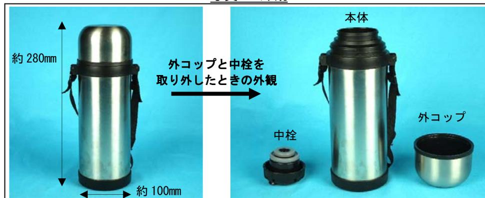
当該品と同型品について、JIS S 2053「ステンレス鋼製まほうびん」を参考に保温効力<sup>(注2)</sup>の比較を行ったところ、当該品は6時間後に28.7℃で、表示の保温効力(6時間後に74℃以上)を大きく下回っていました。一方、同型品は81.1℃で表示値以上の保温効力がありました。赤外線熱画像装置(サーモグラフィ)を用いて、保温効力テスト中の本体外側の表面温度分布を観察したところ、当該品は沸騰水を入れた直後から全体が均一に温度上昇しました。テスト
