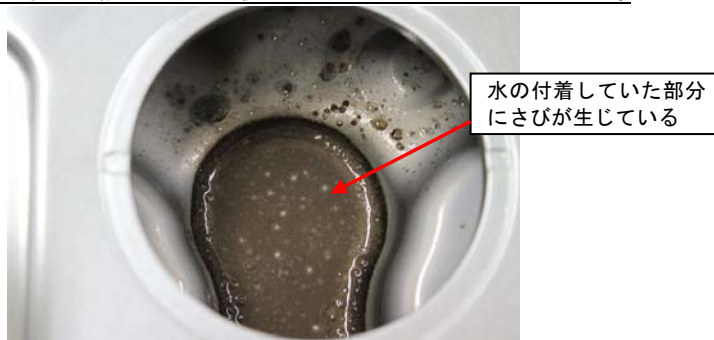
写真 11. 灯油が燃え尽きた後の石油ファンヒーターの内部
