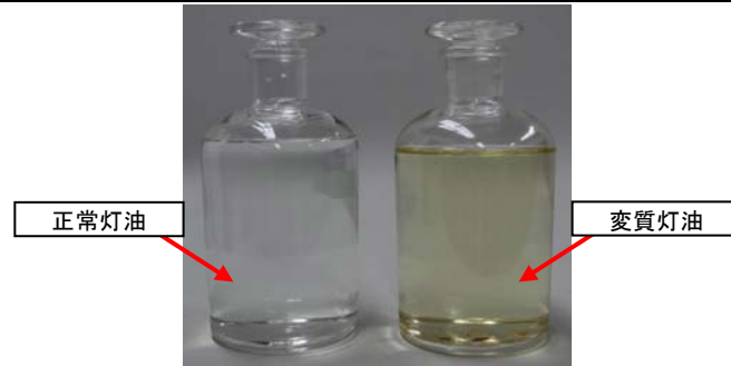
写真4. 灯油専用ではないポリ容器(白)に保管して変質した灯油(右側)
