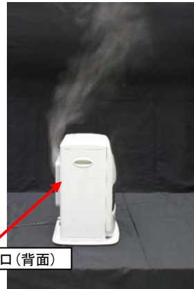
b) 温風取り入れ口(背面)からの発煙
