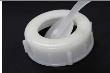
写真5. 劣化して破損したポリ容器のふた(灯油専用ではないポリ容器(白))
