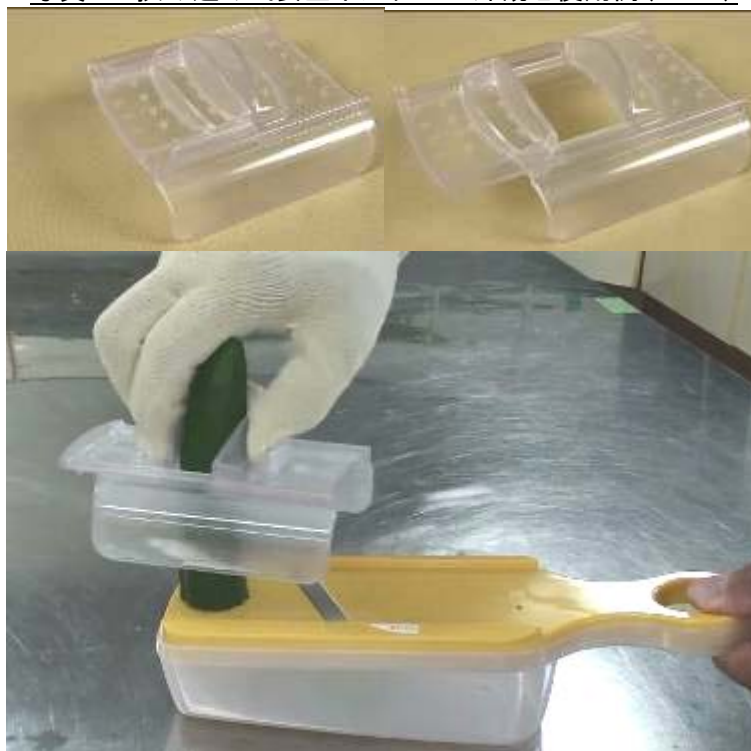
写真5 挟み込み式安全ホルダーの外観と使用例 (No. 10)
