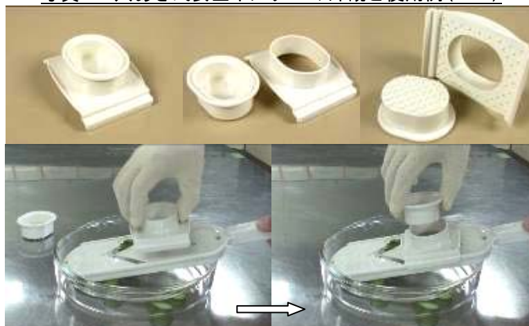
写真3 穴あき式安全ホルダーの外観と使用例(No. 7)
