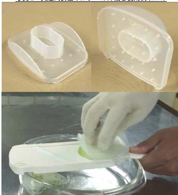
写真2 突起式安全ホルダーの外観と使用例(No. 3)
