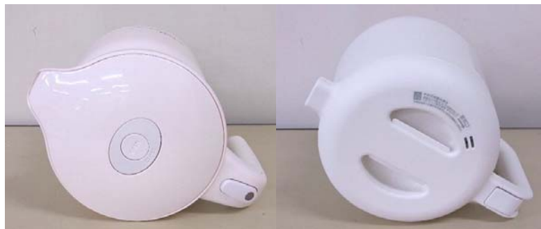
写真2 構造による転倒時のお湯漏れ低減（製品例） （ハンドル部分が重いため、注ぎ口が上を向き全量流出を防ぐ）
