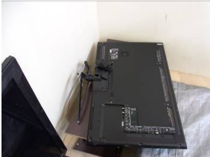
写真3 壁に固定し震度6弱相当で転倒した42V型テレビ
