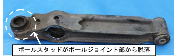
写真 2. ボールスタッドが脱落した左ロアアーム
