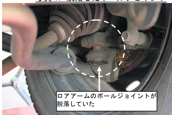
写真 1. 脱落したボールジョイント
