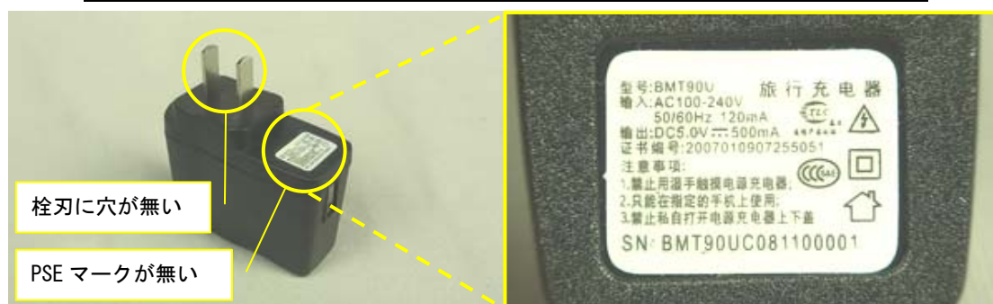
写真 1. PSE マークの表示が見られず、プラグの栓刃に穴がない例 (No. 1)
