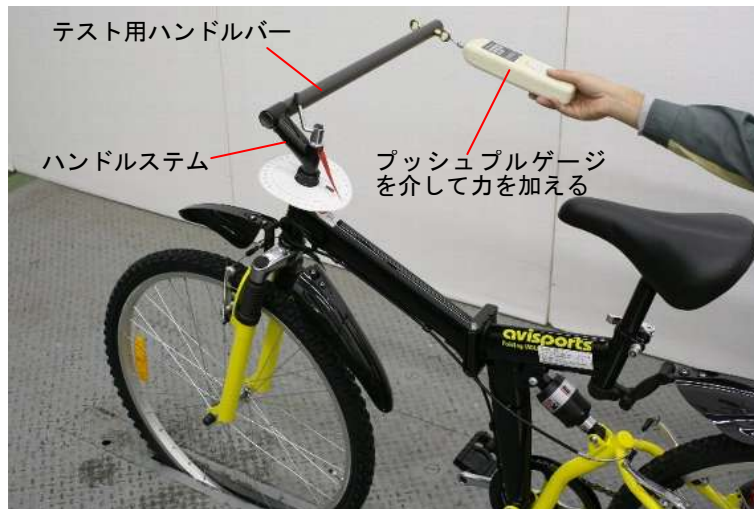
写真5. ハンドルステムの固定力の測定の様子
