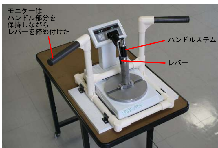
写真 4. レバーを締め付けるトルクを測定する装置の様子
