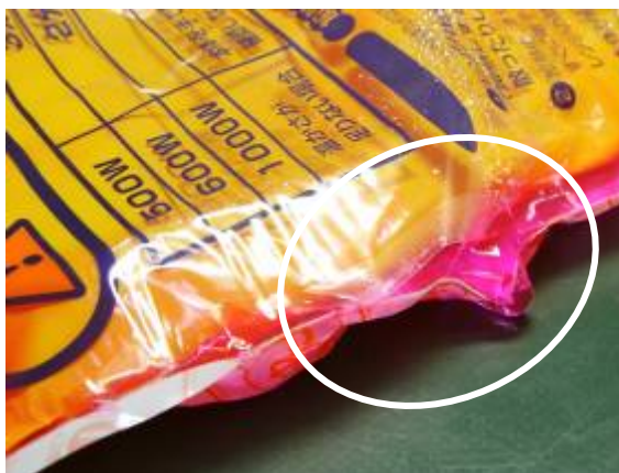
写真6. シーリング部分から外へ漏れ出た例 (No. 3)
