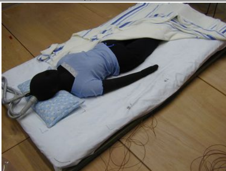
写真2. サーマルマネキン(撮影のためにタオルケットを一部外した)
