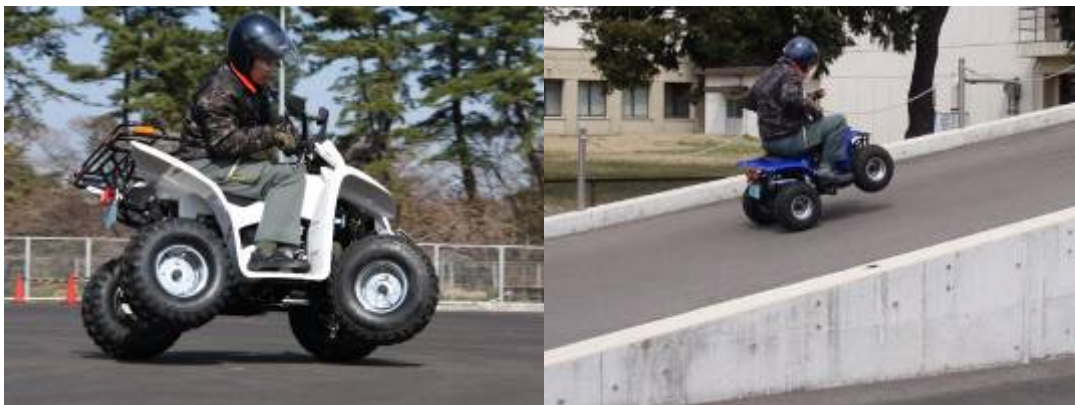
写真 4. 小回りして片輪が浮き上がるNo.5(左)と上り坂の発進で前輪が浮き上がるNo.2(右)の様子
