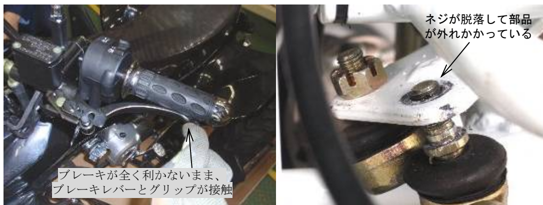
写真 2. 後輪ブレーキが全く利いていなかったNo.3(左)と操舵装置のネジが脱落していたNo.1(右)の様子
