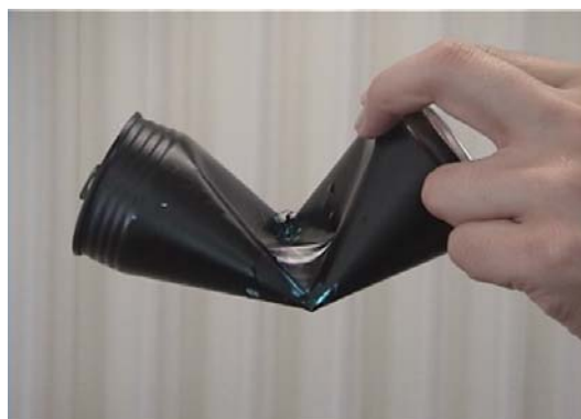
写真 2. 事故同型品の柄（手元）が当たってできた凹み
