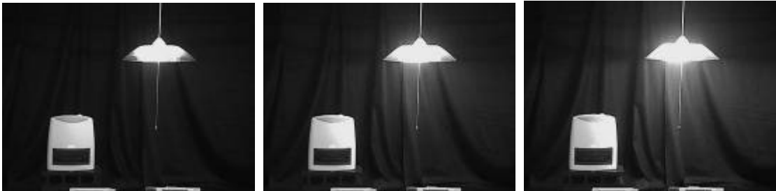
写真2. 中性線欠相後の蛍光灯器具の状態(点滅を繰り返す)
