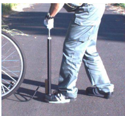
写真 4-a. シリンダ本体の先端が足に接触した様子
