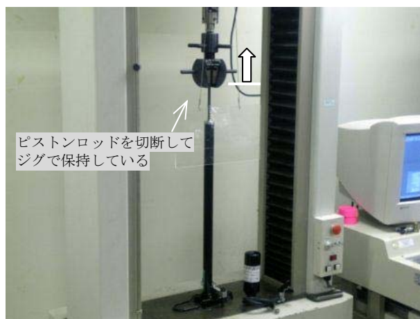
写真 12. ピストンロッドを引き上げたときの台座~ピストンロッドの間の結合強度のテスト
