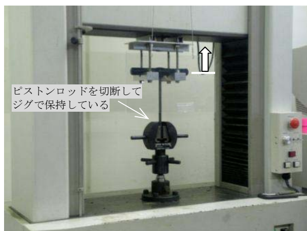
写真 11. 握りとピストンロッドとの結合強度のテスト
