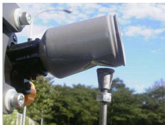
写真 1-b. ピストンロッドが衝突して凹んだアルミ缶
