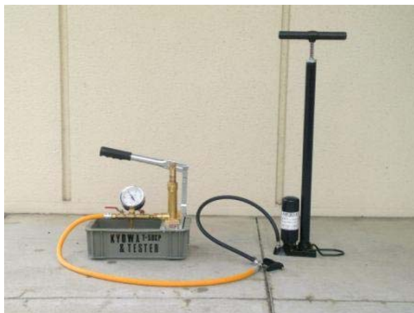
写真 13. 蓄圧タンクの耐圧強度のテスト
