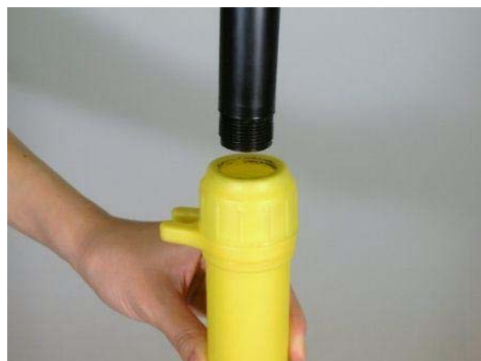
写真 15-a. キャップが外れたもの（一例） 写真 15-b. ピストンロッドがピストンから抜けたもの（一例）
