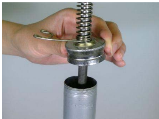
写真 15-a. キャップが外れたもの（一例） 写真 15-b. ピストンロッドがピストンから抜けたもの（一例）
