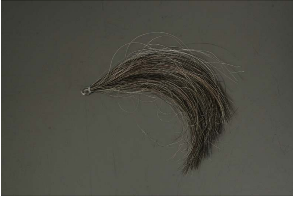
写真3 No.7を表示の基本的な方法に従って染毛した時の様子 染毛性能は低く、染毛する前からの変化がほとんど感じられない、白髪等も目立つ との評価が多かった。
