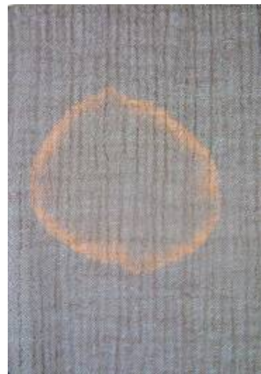
150℃乾熱プレス仕上げの場合 (かなり変色している)
