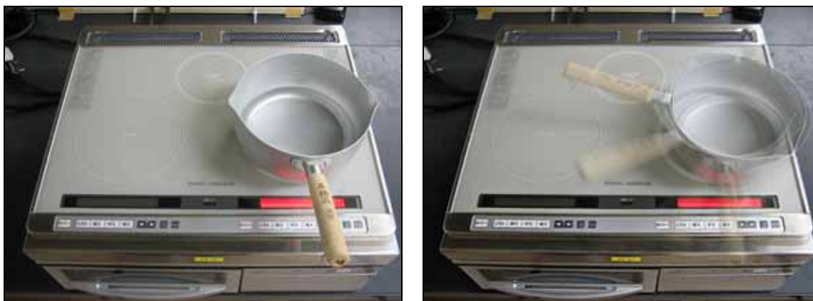
写真 2. アルミ鍋が動き出した様子(左：加熱開始時、右：動いている様子)
