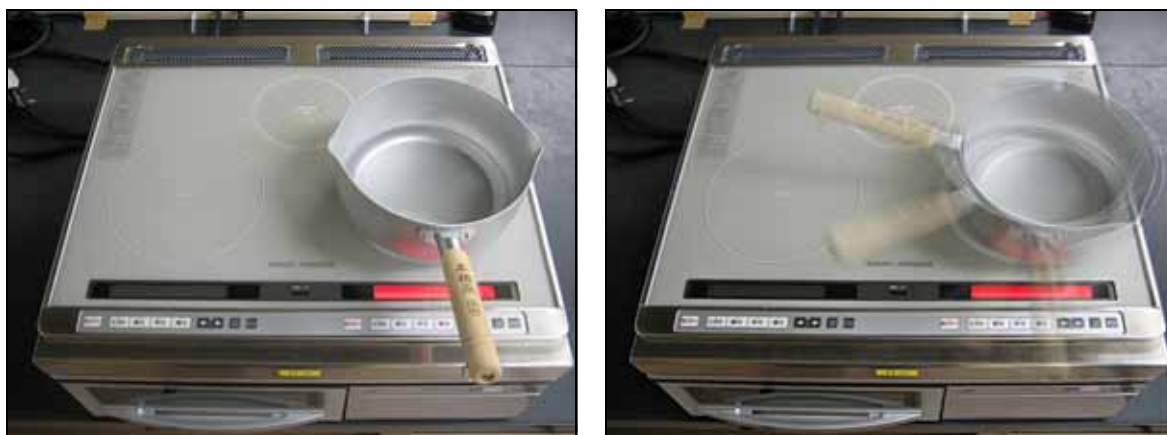
写真 4. アルミ鍋が動き出した様子(左：加熱開始時、右：動いている様)
