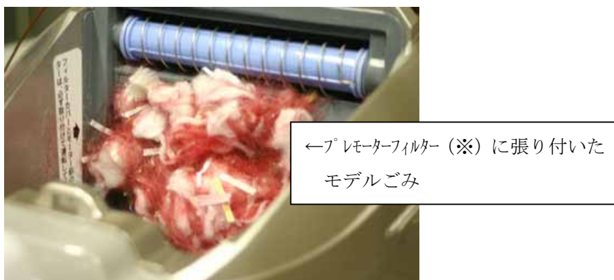
写真6 ダストケースを外した状態で蓋を閉め、モデルごみを吸い込んでしまった状態 (No.2)
