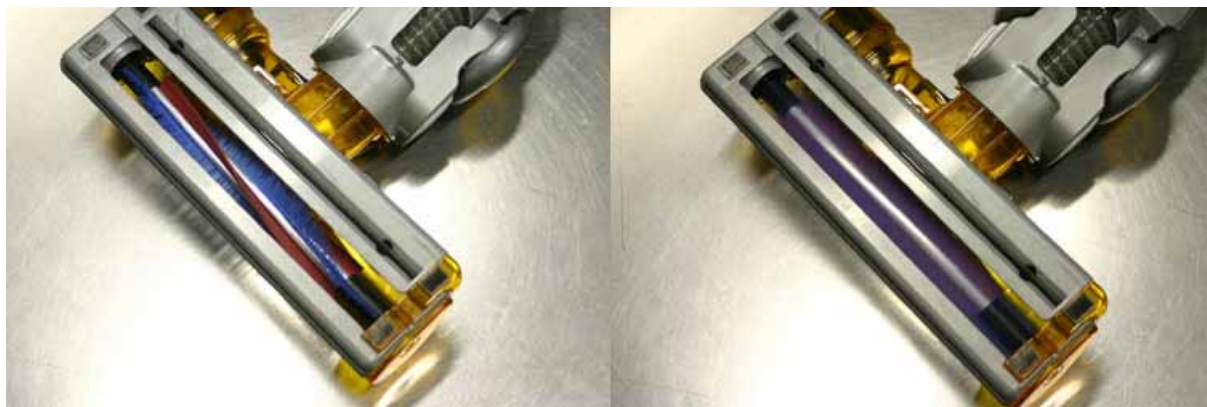
写真 3 裏返した状態で回転し続けるNo.4 の回転ブラシ（左は停止状態）
