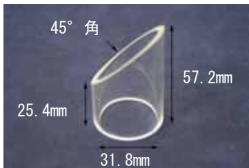
写真2 3歳未満の子どものための玩具をテストする際のテスト円筒
