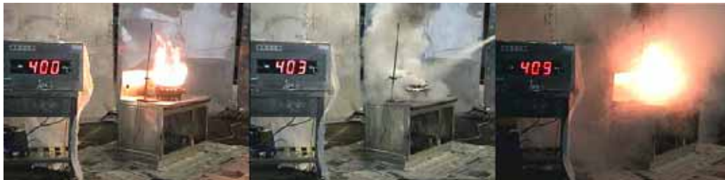
写真 2 ハロンを消火薬剤に使用した商品の消火実験（消防庁資料より）
